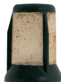
Prefiltro de la E3T obstruido por óxido
